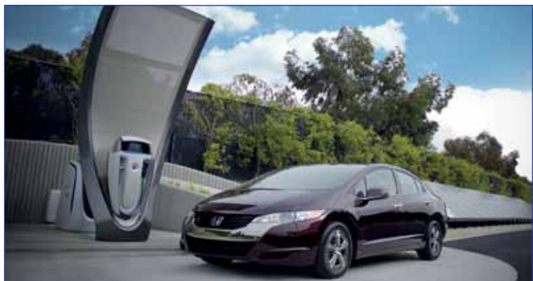
3. ábra. Tüzelőanyag-cellás Honda FCX Clarity személygépkocsi, háttérben egy hidrogén kúttal. A hidrogén előállítása víz elektrolízisével helyben történik, az ehhez szükséges elektromos energiát napelemek biztosítják
