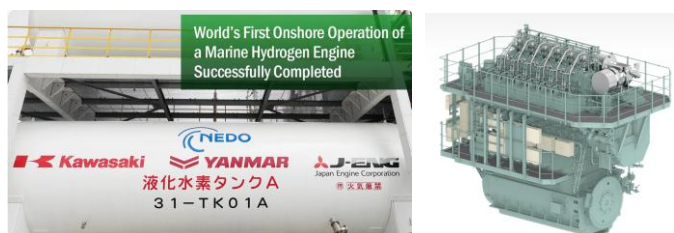
Cseppfolyós hidrogéntartály a szárazföldi tesztüzem helyszínén, és a kétütemű, alacsony fordulátú H 2 -ICE hajómotor sematikus képe.
